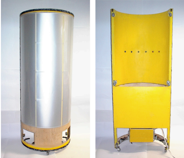
Kuva 5.3.1.1 Olio molemmilta puolilta: ulkopuolella sensorit, sisäpuolella kytkimet, signaalinkäsittelylaite ja säilytyslaatikko.
