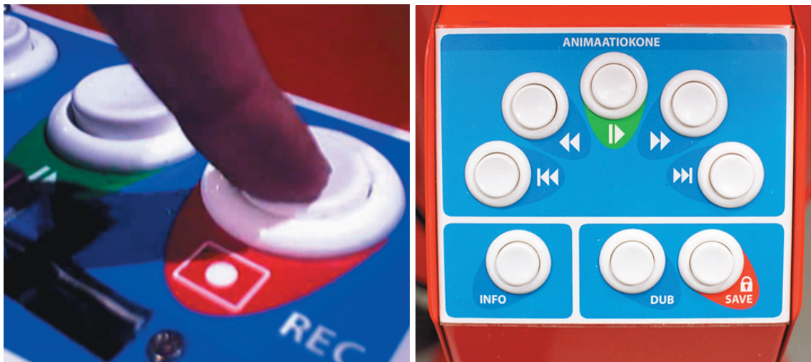
Kuva 5. Vasemmalla animointikupolissa oleva ylempi käyttöliittymä, jota käytetään animaation kuvaamiseen. Oikealla koneen jalustassa oleva alempi käyttöliittymä navigointi- ja erikoistoimintoihin.
