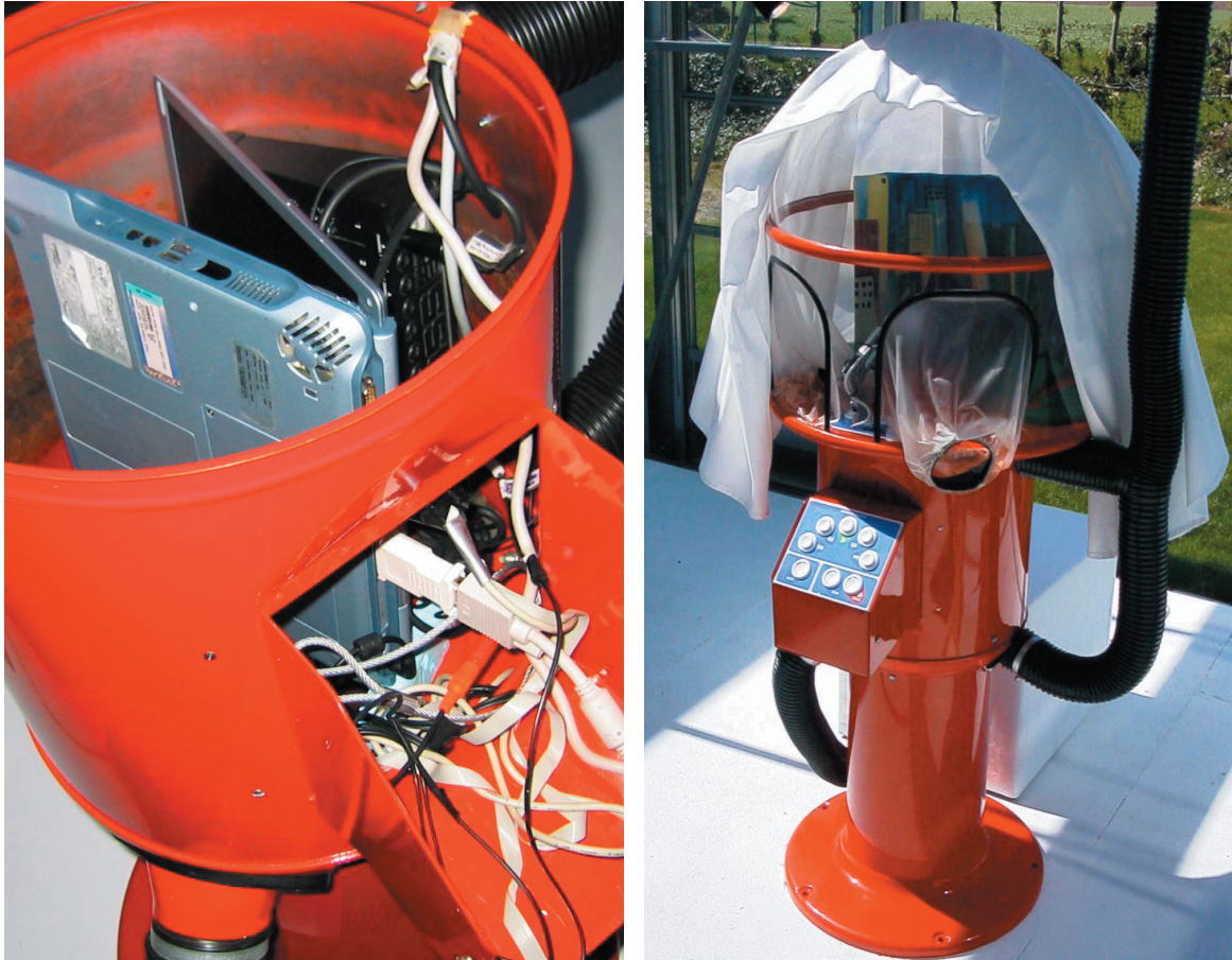
Kuva 28. Jalustaan sijoitettu tietokone kuumenee puutteellisen tuuletuksen vuoksi. Kunsthalle Lophemissa, Belgiassa, auringonpaiste osoittautui todelliseksi ongelmaksi, kuumimpina päivinä kone jouduttiin verhoilemaan. Animointi oli mahdotonta, sillä kupoliin laitettu muoviluvaha sulii hetkessä.
